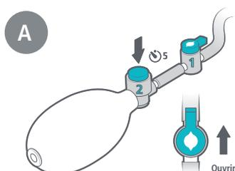
A - Vérifiez que le levier (1) est placé parallèlement au tube (ouvert). Appuyez sur le bouton (2) pendant 5 secondes. Positionnez l'utilisateur dans la position souhaitée, maintenez cette position pendant 10 secondes.
